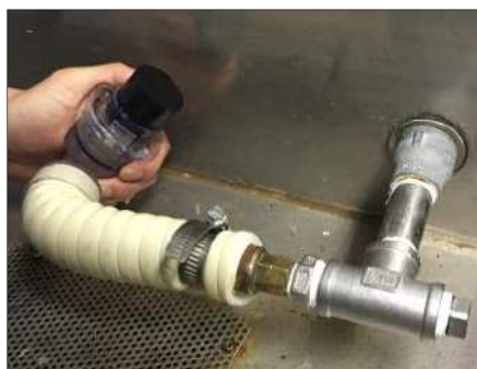
写真1. 気密曲げ試験状況(接着部)
