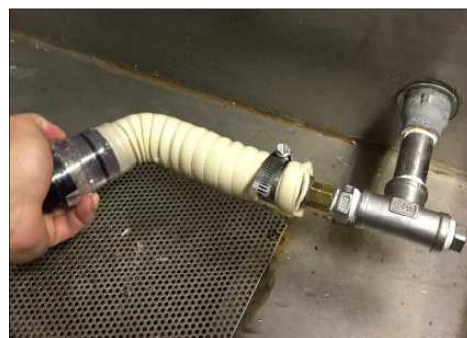
写真2. 気密曲げ試験状況(ホース部)
