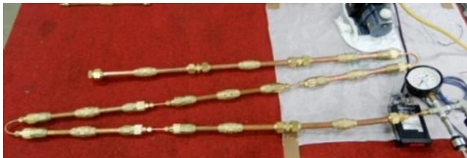
写真7－ 真空試験後の供試体
