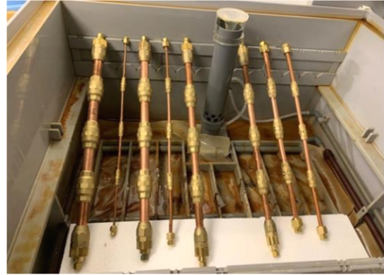
写真12.1-塩水噴霧試験機と供試体
