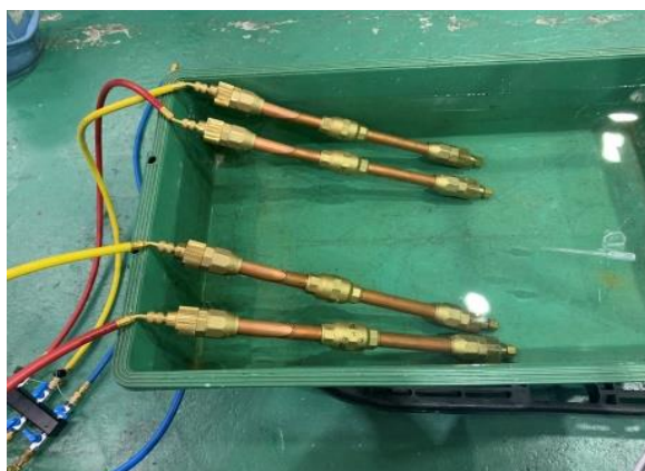
写真9.2－引張試験後の供試体
