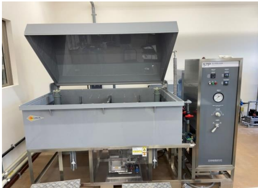
写真12.1-塩水噴霧試験機と供試体
