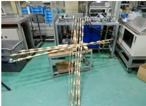
写真8－疲労試験後の供試体
