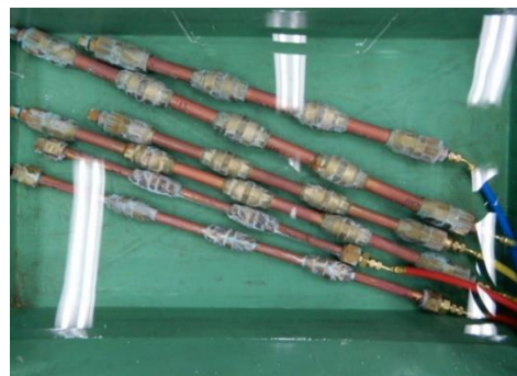
写真12.2-塩水噴霧試験後の供試体
