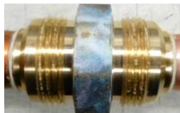
写真12.2-塩水噴霧試験後の供試体
