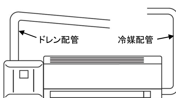
冷媒配管・ドレン配管を別々に取り出し
