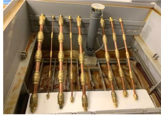
写真12.1-塩水噴霧試験機と供試体
