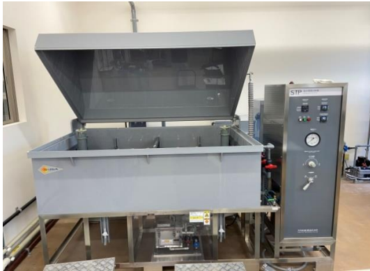
写真12.1-塩水噴霧試験機と供試体
