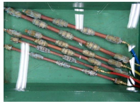
写真12.2-塩水噴霧試験後の供試体
