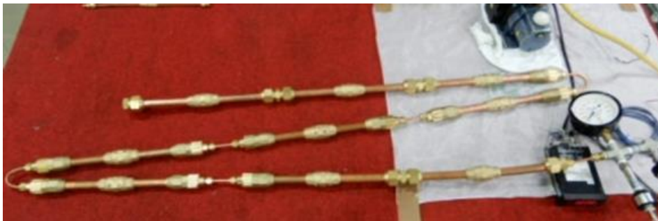
写真7- 真空試験後の供試体
