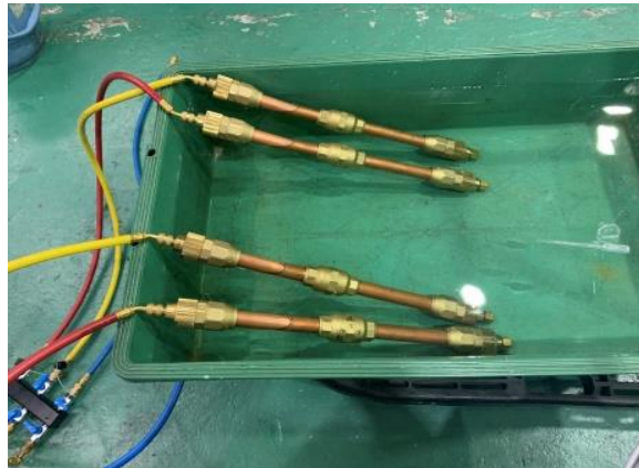
写真9.2—引張試験後の供試体
