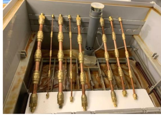
写真12.1-塩水噴霧試験機と供試体
