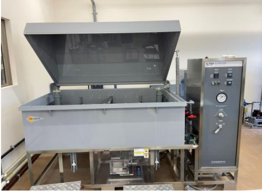
写真12.1-塩水噴霧試験機と供試体
