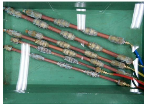
写真12.2-塩水噴霧試験後の供試体
