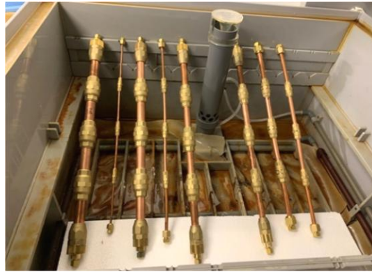
写真12.1-塩水噴霧試験機と供試体
