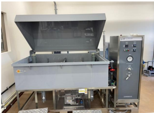
写真12.1-塩水噴霧試験機と供試体
