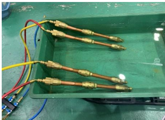
写真9.2－引張試験後の供試体
