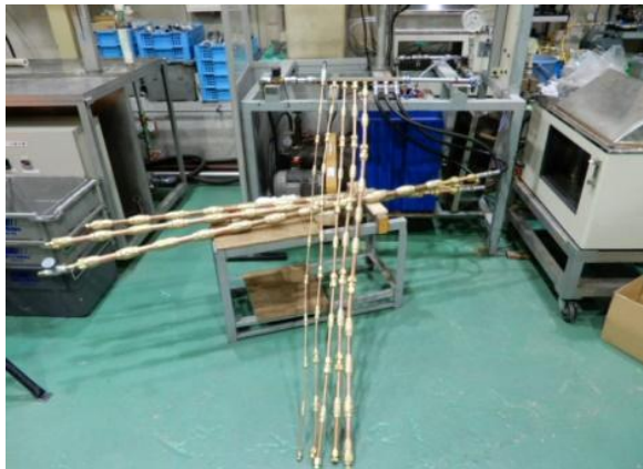
写真8－疲労試験後の供試体
