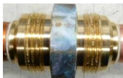
写真12.2-塩水噴霧試験後の供試体
