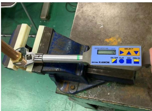
写真14—締付トルク試験
