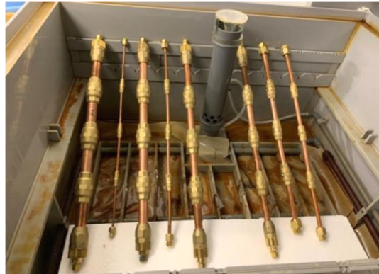
写真12.1-塩水噴霧試験機と供試体
