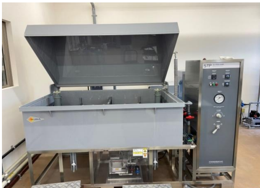
写真12.1-塩水噴霧試験機と供試体
