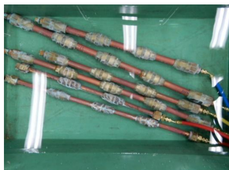
写真12.2-塩水噴霧試験後の供試体
