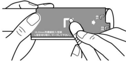
使用する配管径に応じた型紙の端部に配管端部に合わせ、標線を記入(枠内一杯に塗り潰す)してください。
