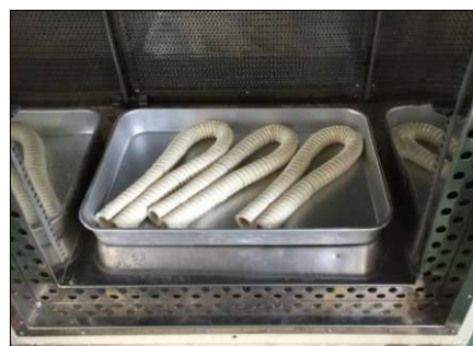
写真6. 恒温槽内部状況 (ホース部)
