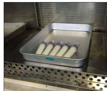
写真7. 恒温槽内部状況 (ソケット部)
