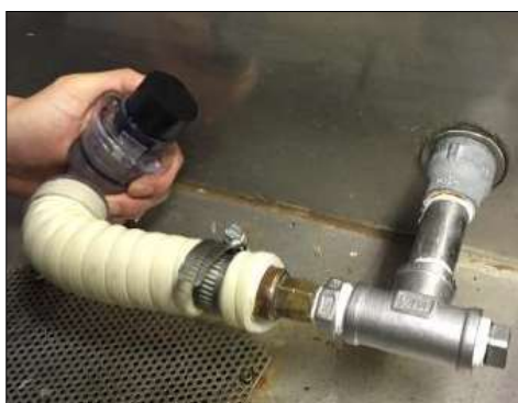
写真1. 気密曲げ試験状況(接着部)
