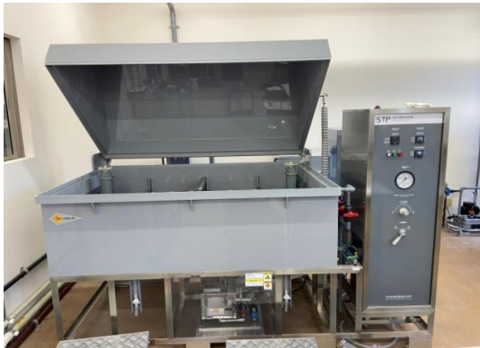
写真12.1-塩水噴霧試験機と供試体
