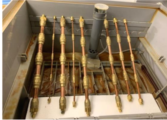
写真12.1-塩水噴霧試験機と供試体
